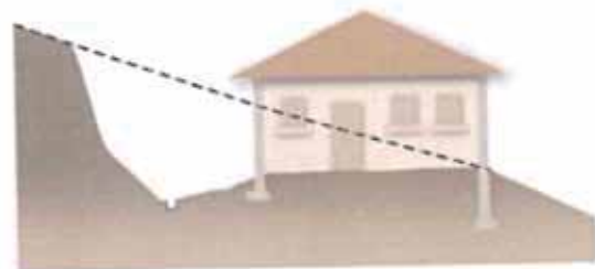
Plate-forme en déblais
